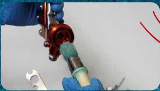
Limpiar el paso de producto
