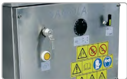
Maneta de apertura, encendido/apagado y temporizador en la puerta frontal.
